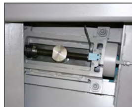
Klingespænding KTECH via elektro-mekanisk system, CNC-styret
