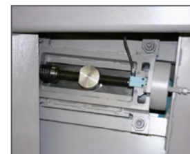
Klingespænding KTECH via elektro-mekanisk system, CNC-styret
