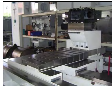
Dobbelte prismeføringer i for tværslæden
