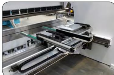
High-speed bagstop med recirkulerende kuglespindler, CNC-styret.
