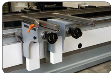
Højdejusterbare frontarme på lineære føringer
