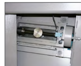
Klingespænding KTECH via elektro- mekanisk system, CNC-styret
