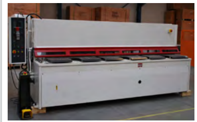
Baykal hydr. maskinsaks Type HGL 3106, årg. 2016 3060 x 6 mm, Cybtouch 6
