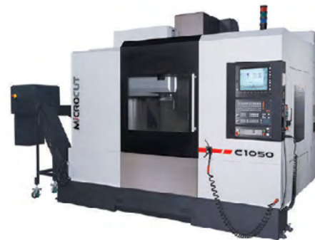
Microcut bearbejdn.center C1050, X/Y/Z:1050/600/600 mm, 10000 omdr./min., Heidenhain
