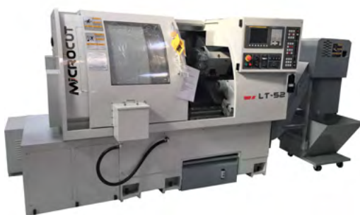
Microcut skråv. drejebænk Type LT-52, med Fanuc 0iTF, CNC-styring, hydr. revolver
