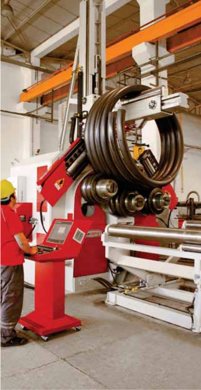
APK 280 Hidrolik Profil Bükme Makinesi dik çalışma pozisyonu
