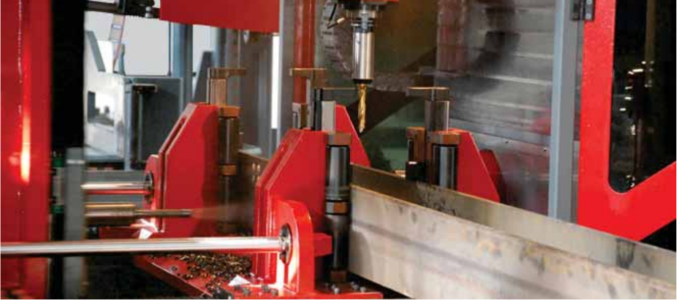
Through 3 independent spindle units on 3 ADM model, the profile can be drilled from 3 sides at the same time. Aynı bağımsız spindle ünitesi sayesinde profilin üç tarafına aynı anda delik delinebilir
