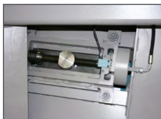
Klingespænding KTECH via elektro-mekanisk system, CNC-styret
