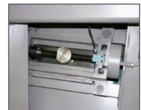
Klingespænding KTECH via elektro-mekanisk system, CNC-styret
