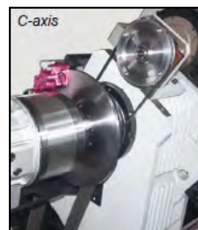
C-akse med bremsesystem muliggør spindelindeksering & giver overlegen ydeevne
