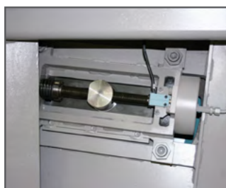
Klingespænding KTECH via elektro-mekanisk system, CNC-styret
