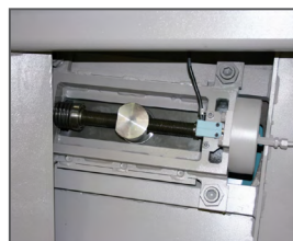
Klingespænding KTECH via elektro- mekanisk system, CNC-styret
