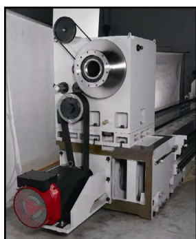
Kraftig spindeldok indbygget i gearkasse
