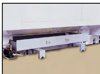
Nem eftermontering af spåntransportør
