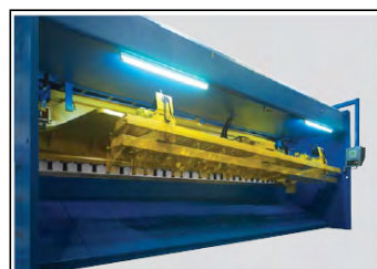
Automatisk sving-op, for længere klip
