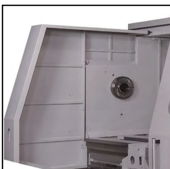
Afskærmet centerpatron med låseanordning
