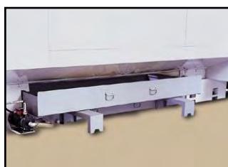
Nem eftermontering af spåntransportør
