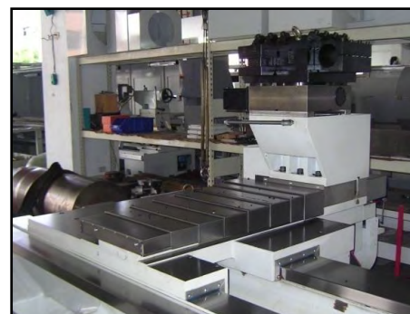
Dobbelte prismeføringer i for tværslæden
