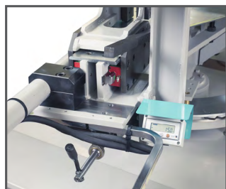
Digital display som viser savbue-vinkel
