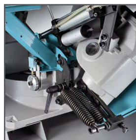
Fjedere til perfekt balance på savbuen
