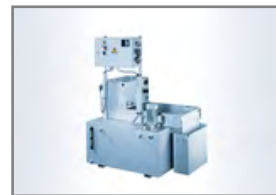
Båndpasfilter med høj- tryks kølepumpe
