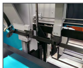
Dobbelt skruestik før og efter klingen, hvilket sikrer perfekt fastholdelse af emnet under driften
