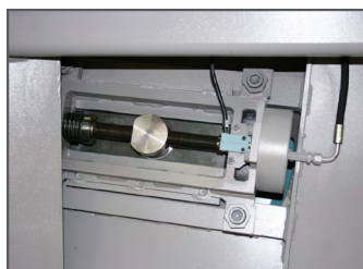
Klingespænding via elektro-mekanisk system, CNC-styret
