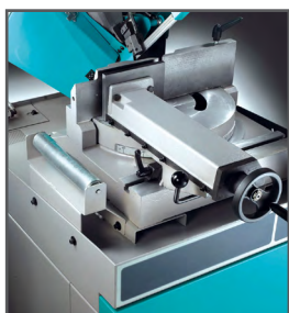
Skruestik med hurtig tilspænding
