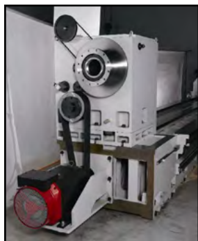
Kraftig spindeldok indbygget i gearkasse
