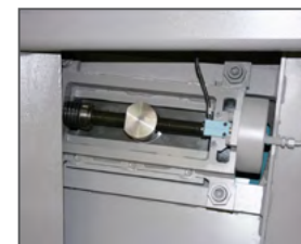
Klingespænding KTECH via elektro-mekanisk system, CNC-styret
