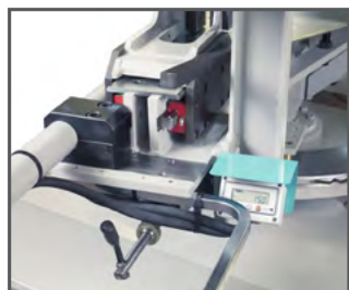
Digital display som viser savbue-vinkel
