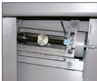
Klingespænding KTECH via elektro-mekanisk system, CNC-styret
