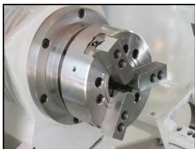
Standard udstyret med hydraulisk 3-bakket centrerpatron
