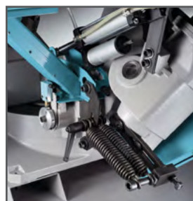
Fjedre til perfekt balance på savbuen
