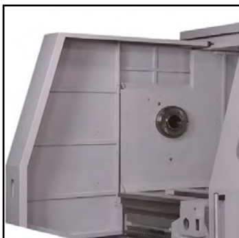
Afskærmet centerpatron med låseanordning
