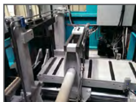
SMART fremføring med indbygget bord
