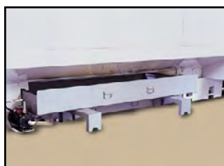
Nem eftermontering af spåntransportør
