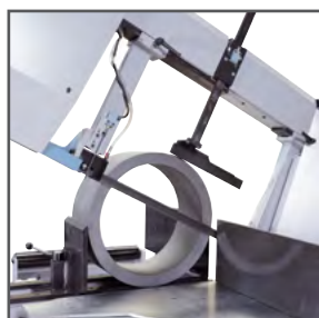
Sensor-anordning for type KS
