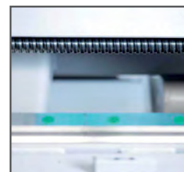
Fødesnegl i alle automatiske NC båndsave
