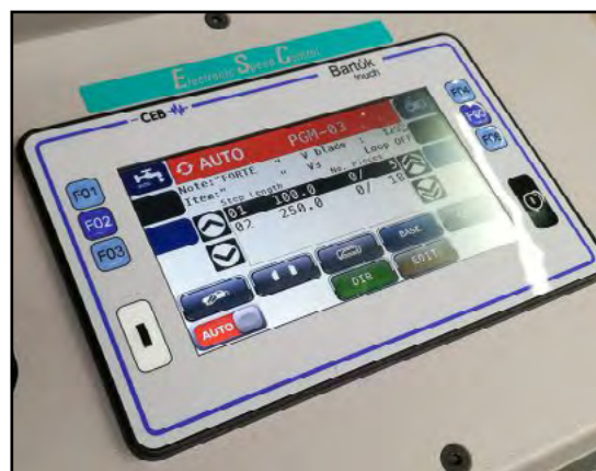
Tastatur til CNC automatisk båndsav
