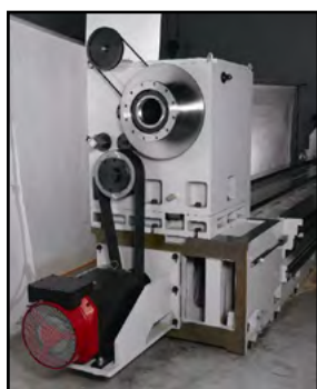
Kraftig spindeldok indbygget i gearkasse
