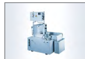
Båndpasfilter med højtryks kølepumpe
