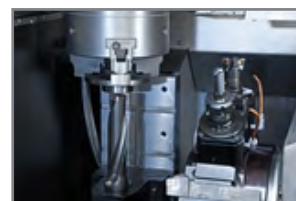
Multifunktionsplade - ved brug af lange boreværktøjer
