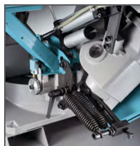
Fjedre til perfekt balance på savbuen
