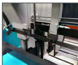
Dobbelt skruestik før og efter klingens, hvilket sikrer perfekt fastholdelse af emnet under driften
