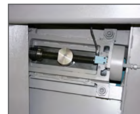
Klingespænding KTECH via elektro-mekanisk system, CNC-styret
