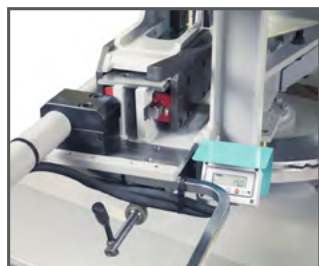
Digital display som viser savbue-vinkel
