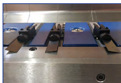
Massiv undervange & fjederfingre på bagstoppet
