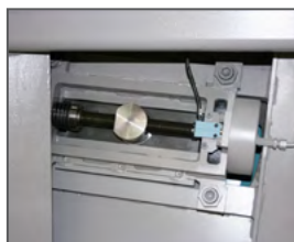
Klingespænding KTECH via elektro-mekanisk system, CNC-styret
