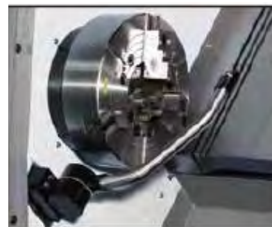
Hydraulisk 3-bakket 18" patron som standard el. 20" patron (opt.)
