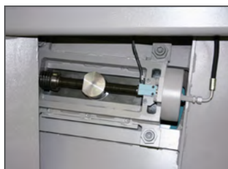
Klingespænding via elektro-mekanisk system, CNC-styret
