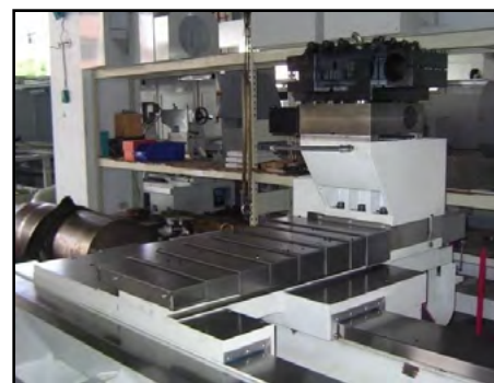
Dobbelte prismeføringer i for tværslæden
