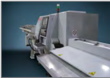
Fjernelse af emner op til 45 mm via modspindel
