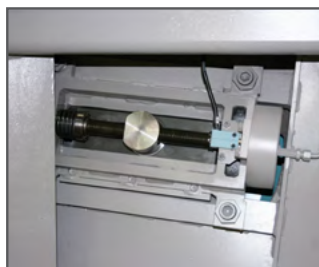
Klingspænding KTECH via elektro-mekanisk system, CNC-styret
