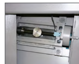
Klingespænding KTECH via elektro-mekanisk system, CNC-styret
