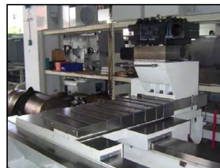
Dobbelte prismeføringer i for tværslæden
