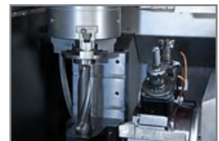
Multifunktionsplade - ved brug af lange boreværktøjer
