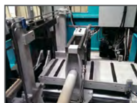
SMART fremføring med indbygget bord
