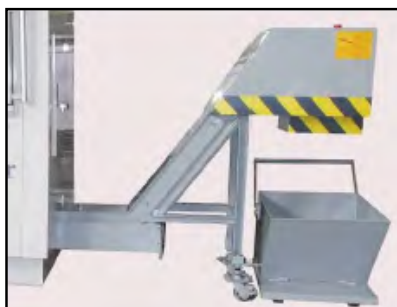
Spåntransportør kan nemt eftermonteres
