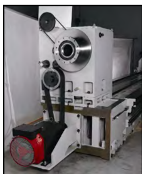
Kraftig spindeldok indbygget i gearkasse
