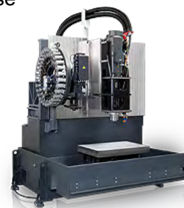
Maskinbase fremstillet af vibrationsdæmpende polymer-beton
