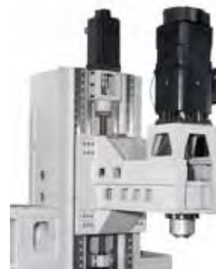
12.000 o./min. in-line spindel
