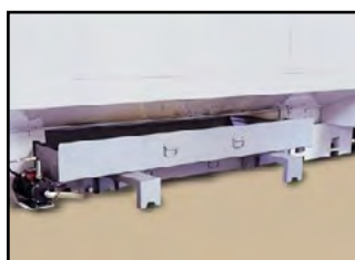
Nem eftermontering af spåntransportør
