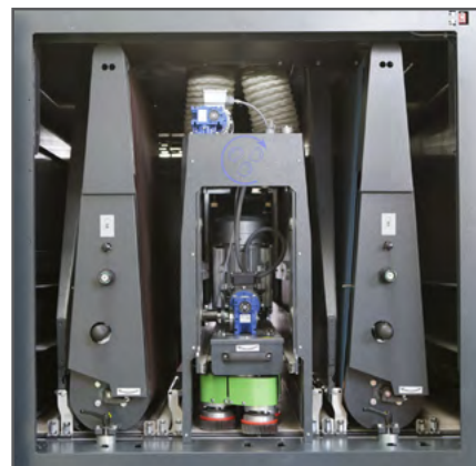
Rulleenhed Ø250 / Tangential børstesystem, Planetarisk system / Elektronisk slibesæt
