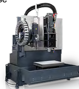
Maskinbase fremstillet af vibrationsdæmpende polymer-beton
