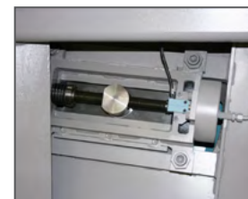
Klingespænding KTECH via elektro-mekanisk system, CNC-styret
