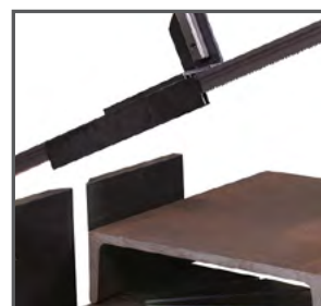
Motoriseret materiale- detektion
