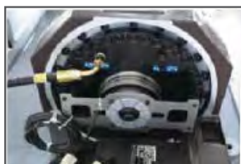
Vinkel-encoder - Højpræcisions vinkel-encoder passer på A-og C-aksen
