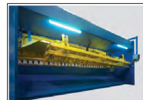
Automatisk sving-op, for længere klip
