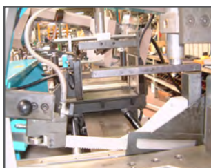
Hydr. anordning til bundtskæring
