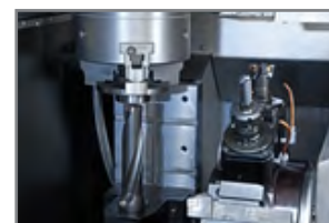
Multifunktionsplade - ved brug af lange boreværktøjer
