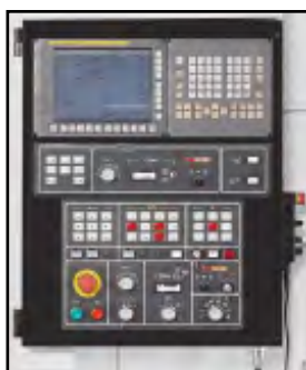
Fanuc 0iTF styring med 10,4" LCD display og Manual Guide i
