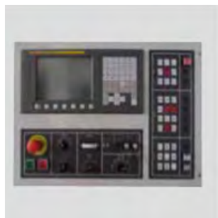
Fanuc OiT m/Manual Guide Oi
