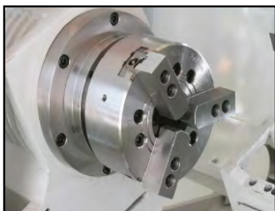
Standard udstyret med hydraulisk 3-bakket centerpatron
