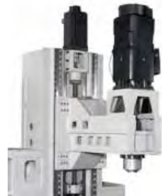
12.000 o./min. in-line spindel
