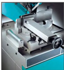
Skruestik med hurtig tilspænding
