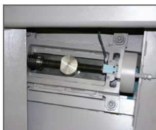
Klingespænding KTECH via elektro-mekanisk system, CNC-styret
