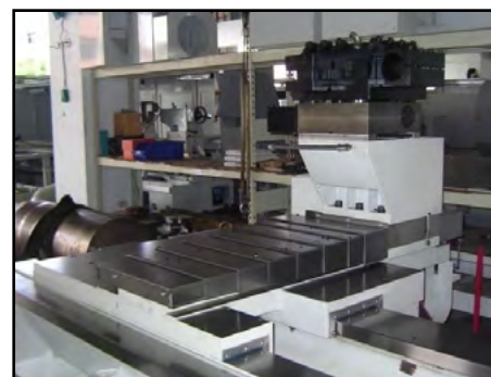
Dobbelte prismeføringer i for tværslæden
